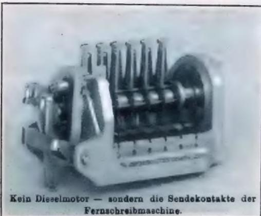
Kein Dieselmotor — sondern die Sendekontakte der Fernschreibmaschine.
